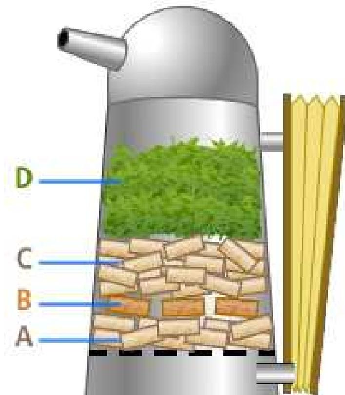
**A :** Déposer une couche de 1 cm de granulés combustible sur la grille au fond de l'enfumoir.
